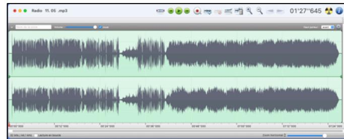
3. Sélectionner le silence de début (pression sur la souris - étendre la sélection, lâcher la pression sur la souris) puis effacer, (touche effacement) puis enlever le silence de fin et effacer (même procédure). S'il y a des passages à effacer dans l'enregistrement : même procédure.
